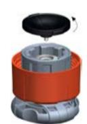
5. Maintenir le volant serré. Visser une membrane neuve à la main (dans le sens des aiguilles d'une montre) dans le boîtier intérieur puis faire tourner la membrane de 90° au moins.
