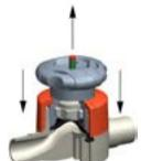
8. Visser l'écrou du boîtier avec une clé à sangle, jusqu'à l'obtention d'un espace de 0,5 à 1 mm entre le corps de robinet et le capot et que l'indicateur de position en demi-cercle s'aligne avec le verrou à friction.
