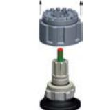
10. Avant de procéder au montage, graisser tous les joints toriques avec de la graisse silicone. Remplacer le joint de l'écrou de pivot et le joint du boîtier intérieur.
