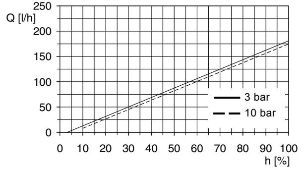
Fig. 95 DMH 175-10 (50 Hz),  $Q_0 = 3$  bar
