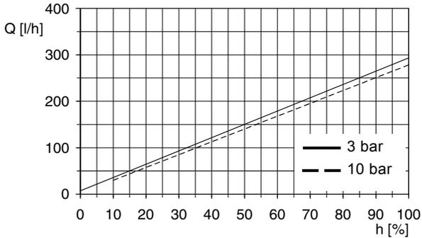
Fig. 111 DMH 270-10 (50 Hz), Q<sub>0</sub> = 3 bar
