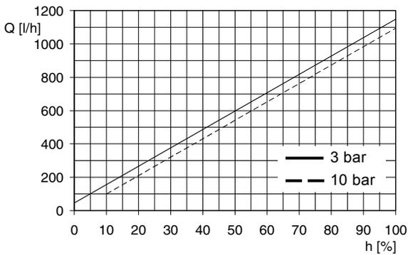
Fig. 129DMH 880-10 (60 Hz),  $Q_0 = 3$  bar
