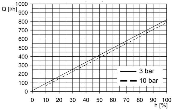
Fig. 126DMH 770-10 (50 Hz),  $Q_0 = 3$  bar
