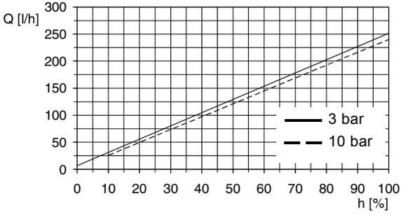
Fig. 110 DMH 194-10 (60 Hz), Q<sub>0</sub> = 3 bar
