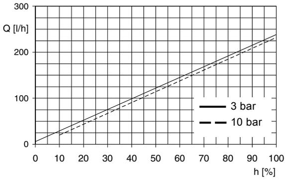
Fig. 118 DMH 220-10 (50 Hz),  $Q_0 = 3$  bar
