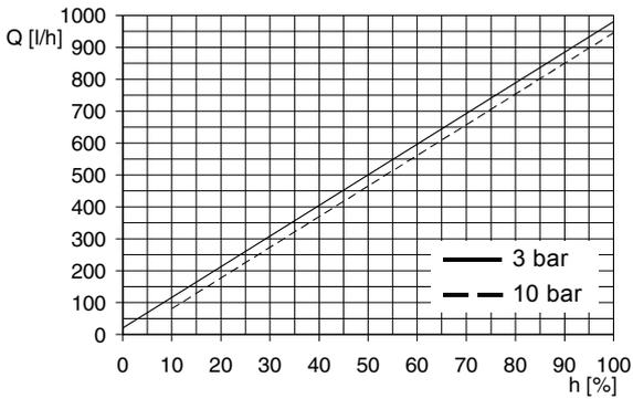
Fig. 127DMH 770-10 (60 Hz),  $Q_0 = 3$  bar
