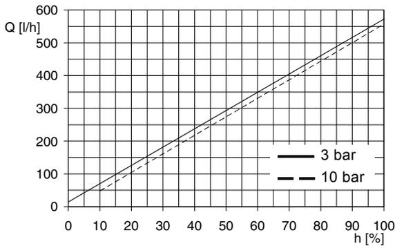
Fig. 121 DMH 440-10 (60 Hz),  $Q_0 = 3$  bar
