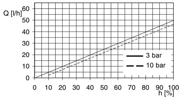
Fig. 72 DMH 46-10 (50 Hz),  $Q_0 = 3$  bar
