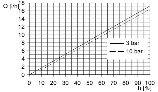
Fig. 47 DMH 13-10 (60 Hz),  $Q_0 = 3$  bar
