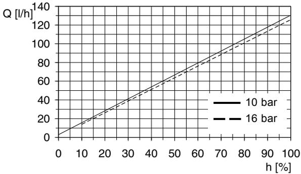
Fig. 101 DMH 97-16 (60 Hz),  $Q_0 = 10$  bar
