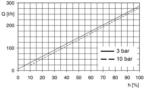
Fig. 119 DMH 220-10 (60 Hz),  $Q_0 = 3$  bar
