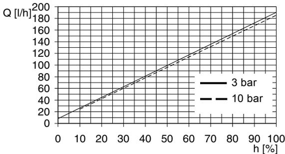
Fig. 94 DMH 143-10 (60 Hz),  $Q_0 = 3$  bar
