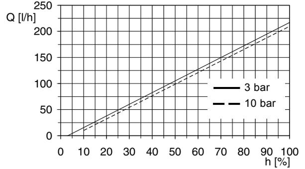
Fig. 96 DMH 175-10 (60 Hz),  $Q_0 = 3$  bar
