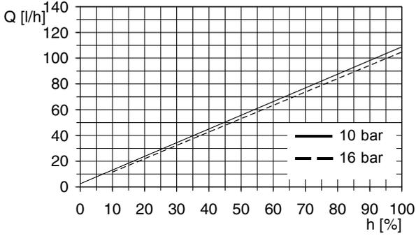
Fig. 100 DMH 97-16 (50 Hz),  $Q_0 = 10$  bar
