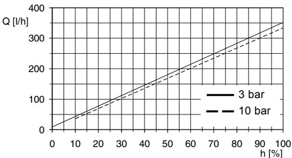
Fig. 112 DMH 270-10 (60 Hz), Q<sub>0</sub> = 3 bar
