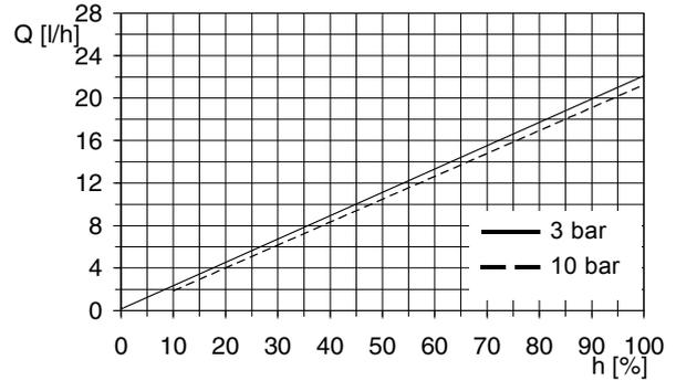
Fig. 48 DMH 19-10 (50 Hz),  $Q_0 = 3$  bar
