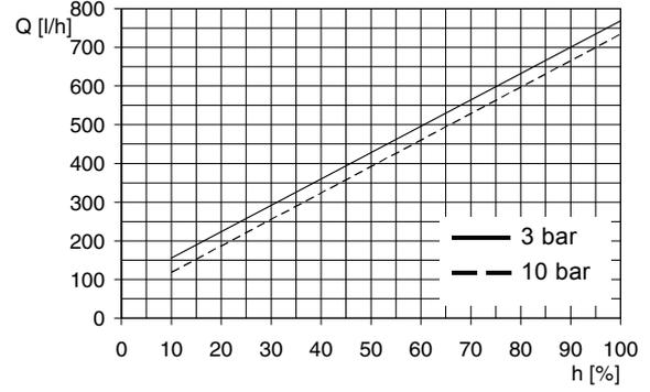
Fig. 123 DMH 575-10 (60 Hz),  $Q_0 = 3$  bar
