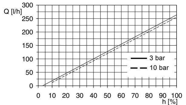
Fig. 98 DMH 213-10 (60 Hz),  $Q_0 = 3$  bar
