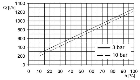
Fig. 130DMH 1150-10 (50 Hz),  $Q_0 = 3$  bar
