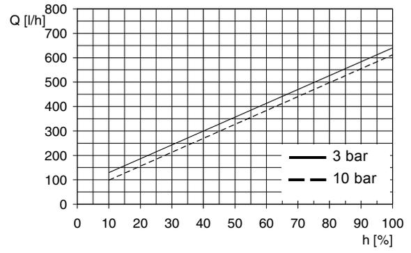
Fig. 122 DMH 575-10 (50 Hz),  $Q_0 = 3$  bar
