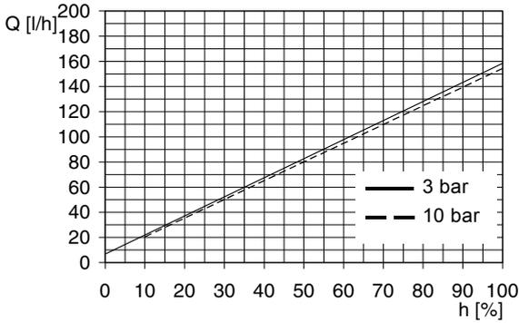
Fig. 93 DMH 143-10 (50 Hz),  $Q_0 = 3$  bar
