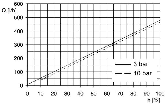
Fig. 120 DMH 440-10 (50 Hz),  $Q_0 = 3$  bar
