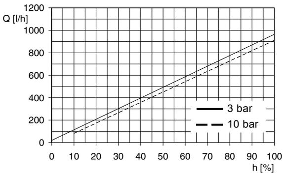
Fig. 128DMH 880-10 (50 Hz),  $Q_0 = 3$  bar
